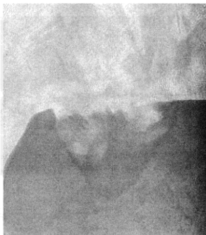
図4-6-22 TEM像 (拡大像): ゲート酸化膜が欠損し、Poly-Siが入りこんでいるのが分かる
